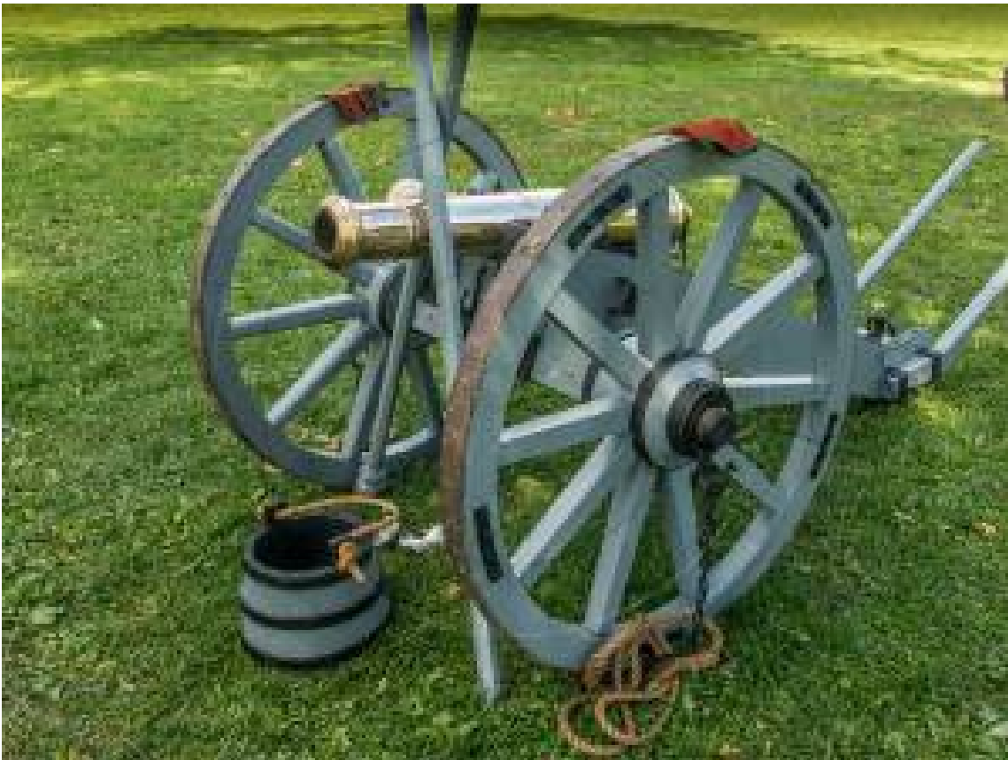
Grasshopper cannon ohne Munitionskisten. Die abgeknickten hinteren Holme sind gut erkennbar. Die Klammer zur Aufnahme des linken vorderen Holms ist hinter der Radspeiche gut erkennbar.
