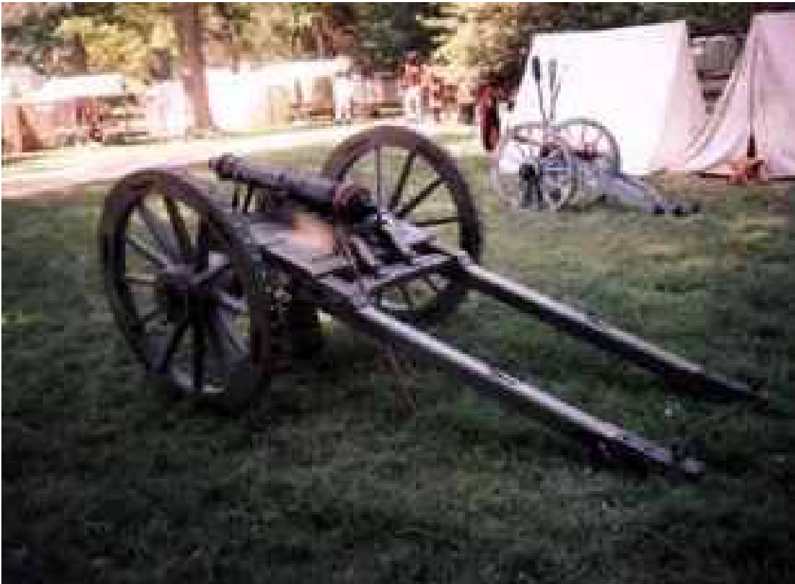
Amerikanische 4-pdr galloper gun mit den beiden hinteren Stangen zum Anschirren eines Pferdes. Die 2 seitlichen Munitionskisten fehlen hier. Sie wären auf den Brettern neben dem Rohr gelagert.
